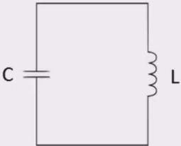
Einen geschlossenen Stromkreis mit einem Kondensator und einer Spule nennt man »Schwingkreis«.
