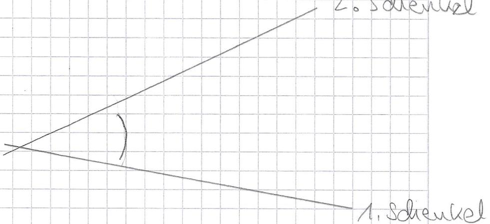
Das Gleichseitige mit der langen Seite so an den 1. Schenkel anlegen, dass die „O“ mit dem Scheitelpunkt zusammenfällt.
